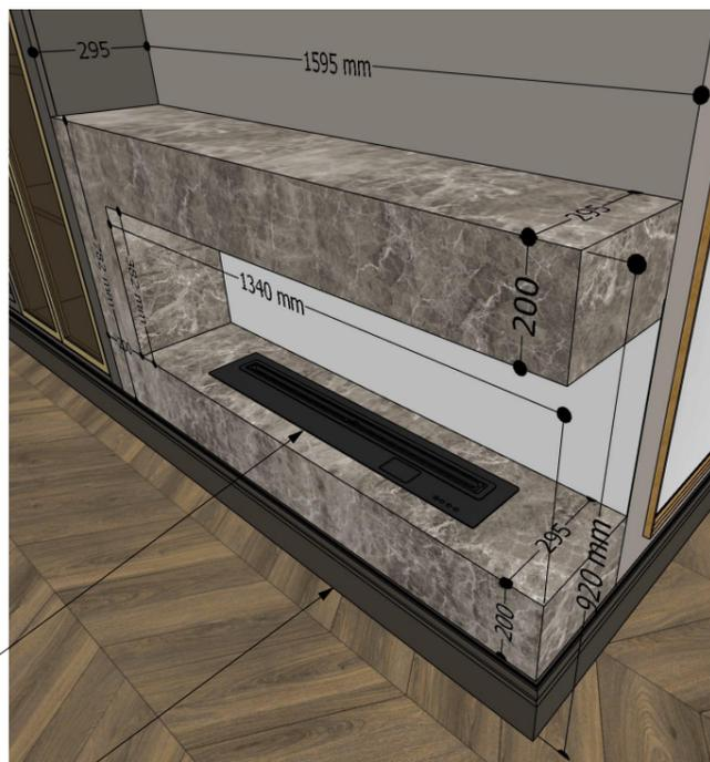
Встроенный топливный блок
